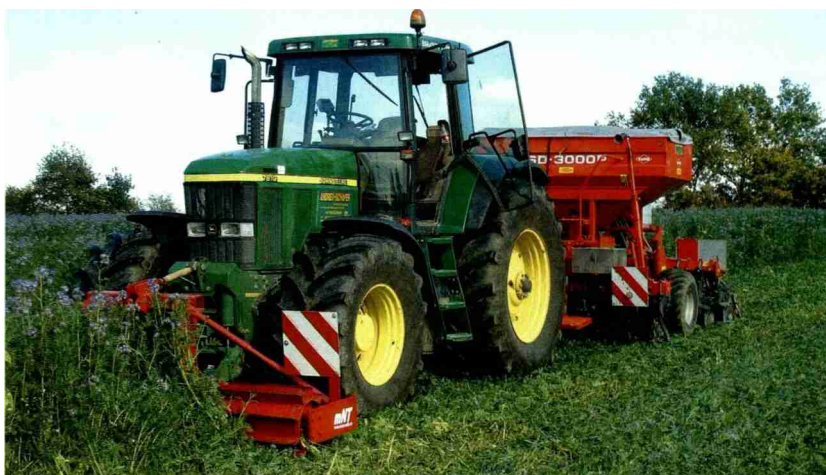
Garantiert ein sicheres Absterben: Die Messerwalze mNT-No-Till quetscht die Gründungen anstatt sie zu schneiden.
