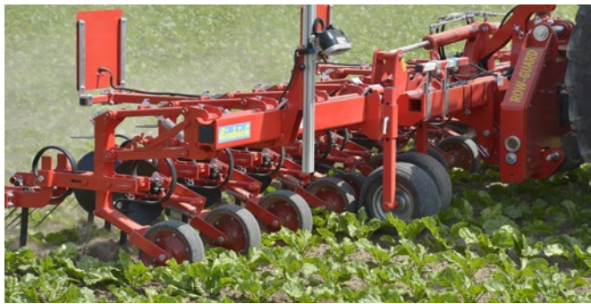
Abb. 1: Die Kamera detektiert zwei Pflanzenreihen und steuert den Querverschieberahmen dynamisch nach. (Foto: Einböck GmbH)
