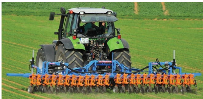
Abb. 2: Mit einzelnen Kameras separat angesteuerte Hackfelder für das Hacken über mehrere Säarbeitsbreiten hinweg. (Foto: Schmotzer)
