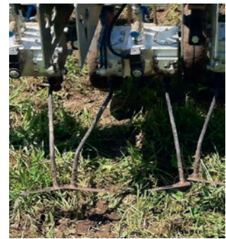
Abb. 3: Hacken innerhalb der Pflanzenreihen. Links der Garford-In-Row-Weeder, rechts der Poulsen-Robovator. (Foto links: Garford, rechts: Poulsen)
