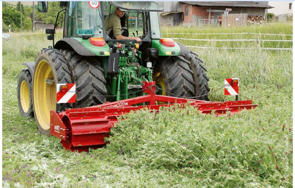
Messerwalze im Einsatz auf einem Leguminosengemenge.
